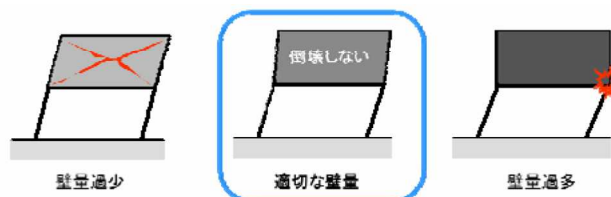
図4 佐原地区まちなみおよび通し柱架構を持つ町屋建築の構造の考え方
